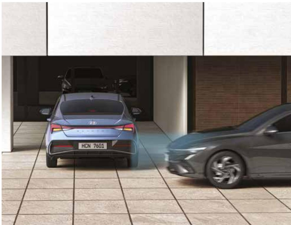
**Система предотвращения столкновений с транспортными средствами, движущимися в поперечном направлении сзади (RCCA)**
